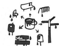
Všechny objekty a prvky (výložníky, svítidla, skříň zařízení atd.) umisťené na nadzemních prvcích technické a dopravní infrastruktury musí být opatřeny shodnou povrchovou úpravou jako prevek nosný.
